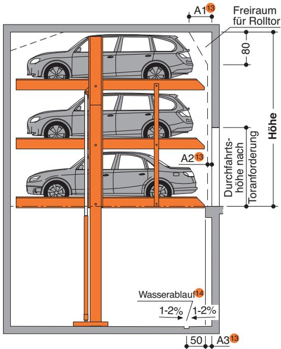
**13** Die Maße A1, A2 und A3 müssen bauseits mit dem Torhersteller abgestimmt werden.
